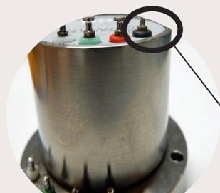
リード線・端子の確実な半田付け、周辺の配線補強は、信号の安定につながります。「より正確な計測」への1歩です。
