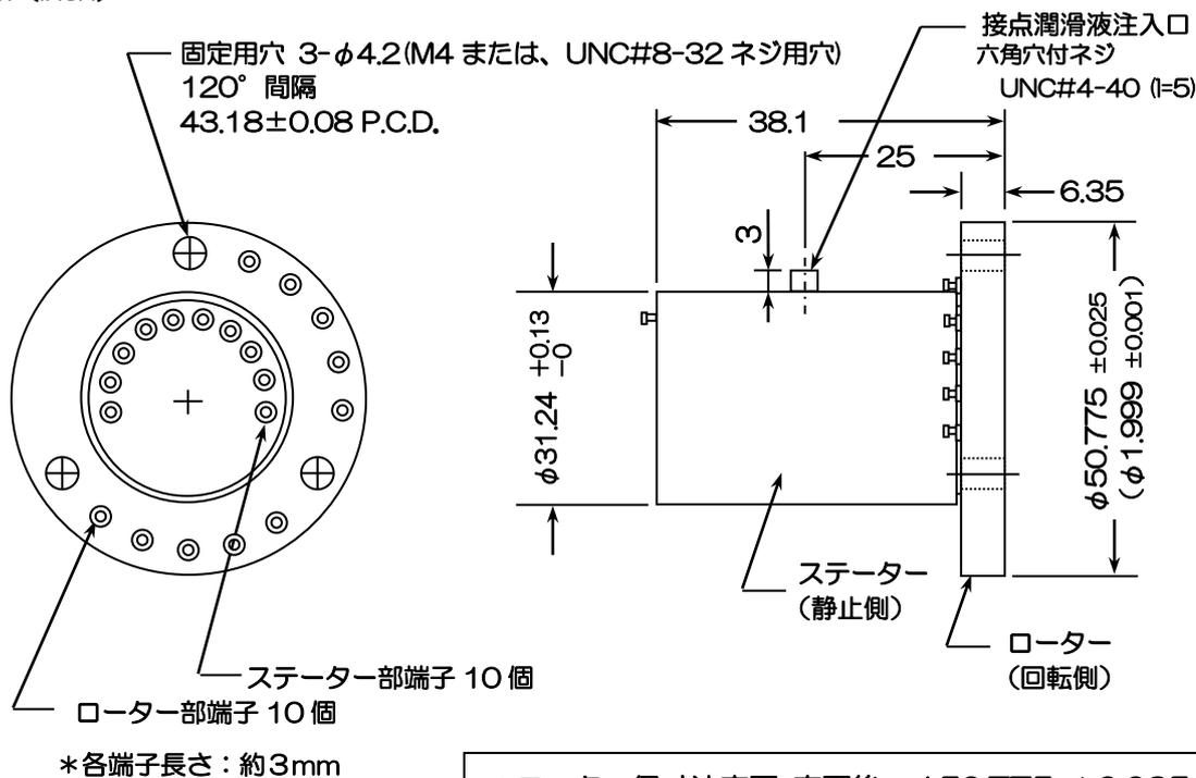
\*ローター径寸法変更 変更後 : φ50.775 ±0.025
